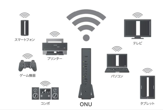
お客さま宅に設置する光回線終端装置 (ONUホームゲートウェイタイプ) は、無線LAN親機能を標準装備しています。パソコン、タブレット、ゲーム機器等さまざまな機器に繋げて、家中どこでも快適生活! 最大速度1.3Gbps※1の無線LAN通信を追加料金なしでご利用いただけます。
